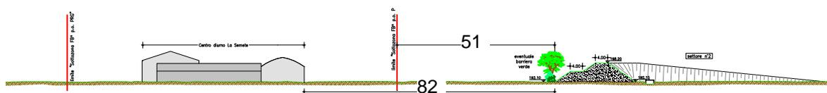
Figura 1-8: distanze degli edifici esistenti e del limite della sottozona FB\* dal piede del rilevato arginale (sezione A-A-estratto elaborato T5).
